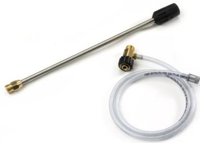
**Reinigungsmittelinjektoren** verzehren ca. 30 % der Reinigungsenergie, ganz gleich ob sie im Einsatz sind oder nicht. Um dem Nachteil des permanenten Druckverlustes zu entgehen, wurde der Reinigungsmittelinjektor beim Kränzle 7/120 als separates Teil ausgebildet, welches nur beim Einsatz von Zusatzmitteln auf den Hochdruckausgang aufgeschraubt wird.
