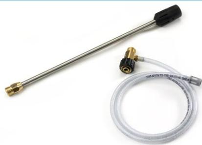
**Reinigungsmittelinjektoren** verzehren ca. 30 % der Reinigungsenergie, ganz gleich ob sie im Einsatz sind oder nicht. Um dem Nachteil des permanenten Druckverlustes zu entgehen, wurde der Reinigungsmittelinjektor beim Kränzle 10/120 als separates Teil ausgebildet, welches nur beim Einsatz von Zusatzmitteln auf den Hochdruckausgang aufgeschraubt wird.
